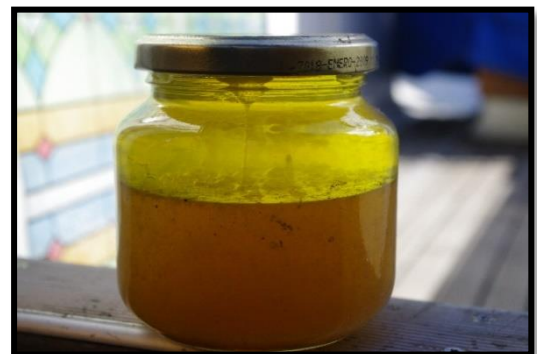
GELIFICACIÓN DEL COMBUSTIBLE
